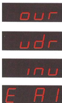
Термоелемент с разменени полюси, евентуално грешен тип термоелемент при температура на пещта много под 0°C (underrun)
